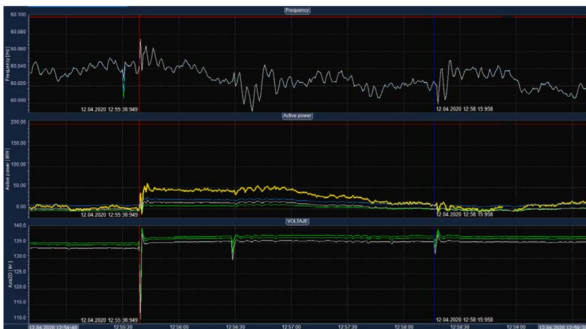
Figura No.3 – Frecuencia y potencia vistos desde las líneas de interconexión 230-10 (Subestación Progreso – Subestación Río Claro), 230-21 (Subestación Changuinola – Subestación Cahuita) y 230-25B (Subestación Dominical – Subestación Río Claro); y perfil de voltaje en 230 kV visto desde la línea de transmisión 230-4A (Subestación Panamá – Subestación Chorrera). Datos extraídos de las Unidades de Medición Fasorial instaladas en las interconexiones y en la LT 230-4A.
